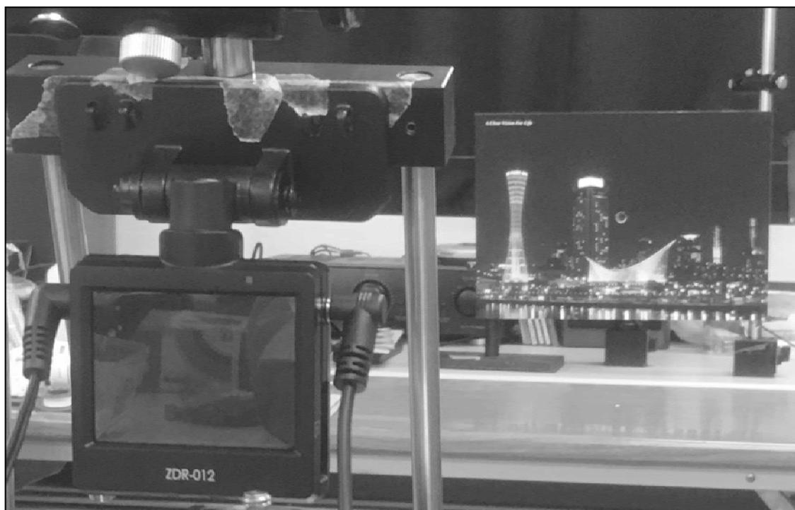
D) 夜間背景画像中央部に設置した点光源：6段階に照度を調節（左：低照度、右：高照度）
